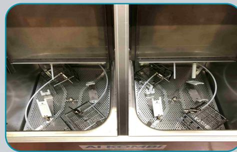
2 bacs de lavage pour nettoyer simultanément, par bac, jusqu'à 2 pistolets gravité et 1 autre pistolet sans godet
