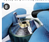
8 Oczyszczyć pozostałe otwory głowicy za pomocą odpowiedniego rozmiaru igły czyszczącej.
