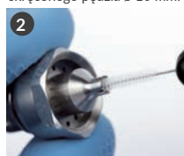
2 Wyczyścić centralny otwór dyszy za pomocą małej, skręconej szczotki \varnothing 3 mm
