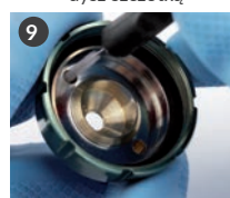
9 Oczyszczyć otwory wewn. części głowicy za pomocą najbardziej odpowiedniego rozmiaru igły czyszczącej
