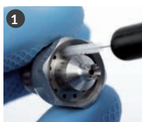
1 Oczyszczyć małe otwory dyszy za pomocą drobnego skręconego pędzla \varnothing 3 mm
