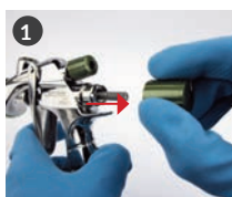
1 Zdejmij pokrętło regulacji materiału i wyciągnij sprężynę
