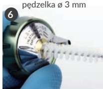
6 Wyczyścić otwór głowicy za pomocą odpowiedniego rozmiaru skręconej szczotki
