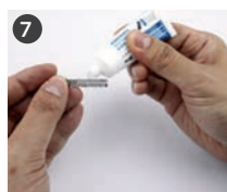
7 Nasmaruj sekcję sprężyny iglicy i włóż sprężynę w jej gniazdo
