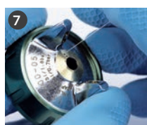
7 Wyczyścić drobne otwory korka powietrznego za pomocą igiełek czyszczących o odpowiednim rozmiarze.
