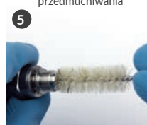
5 Wyczyścić wewnętrzną część dyszy, używając odpowiedniej wielkości szczotki
