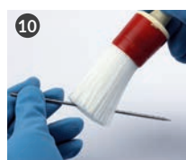
10 Oczyszczyć iglicę za pomocą odpowiedniej szczotki
