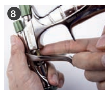
8 Nasmaruj pręt zaworu powietrza za spustem
