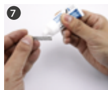
7 Nasmaruj sprężynę iglicy i włóż sprężynę w jej gniazdo
