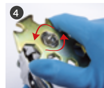
4 Odkręć i zdejmij dyszę kluczem uniwersalnym (kod 930171A0).
