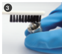
3 Oczyszcz dokładnie końcówkę dyszy za pomocą szczotki (kod W2COM6163)
