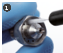
1 Oczyszcz małe otwory dyszy za pomocą małej, skręcanej szczotki (kod W2COM6127)*
