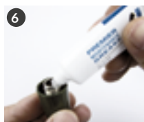
6 Nasmaruj gwinty pokrętła regulacji materiału (kod W2COM6165).
