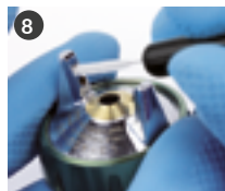
8 Oczyszcz pozostałe otwory głowicy za pomocą specjalnej igły czyszczącej (kod W2COM6127)*
