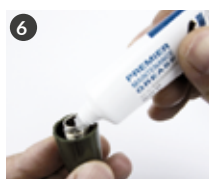
6 Nasmaruj gwinty pokrętła regulacji materiału (kod W2COM6165).
