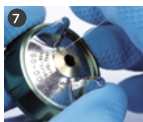
7 Oczyszć drobne otwory głowicy za pomocą igielki (kod W2COM6164)*
